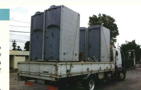
A. トイレカーは「2つの個室」と「手洗い場」の3つの大きな要素を小さな車両の荷台に搭載しています。トイレ空間は充分なスペースを確保しているのでどなたも快適に使用できます。従来の仮設トイレでは3つの設備(大便器・小便器・手洗い場)を一度に移動させることは困難で、設置・撤収に手間とコストが掛かっていましたが、このトイレカーなら自走式なので設置・撤収が簡単に行なえます。
